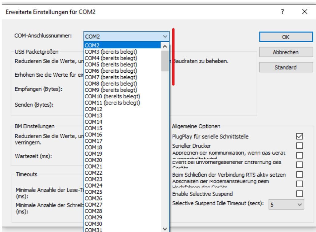
Die Software sucht nur COM-Ports 1-4 ab. Wurde automatisch ab Port 5 eingetragen wird die Datenbox nicht erkannt.
